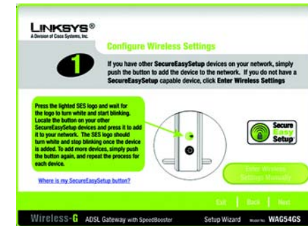
Abbildung 5-18: Setup-Assistent – Fenster Configure Wireless Settings (Konfigurieren der Wireless-Einstellungen) – SecureEasySetup
